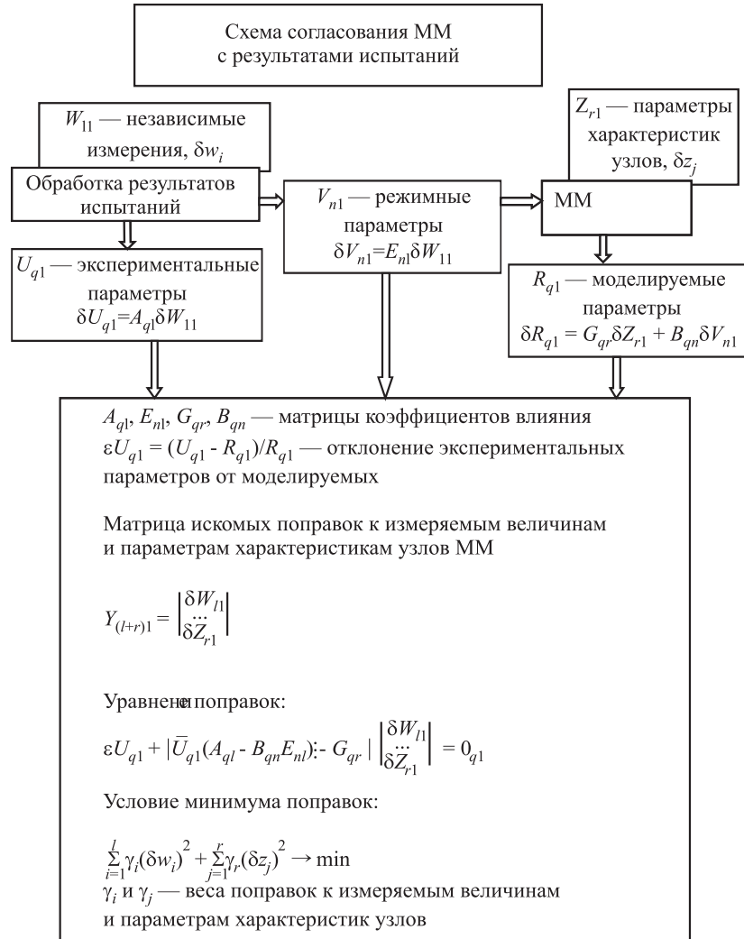
Рис. 1 Схема локального согласования ММ с результатами испытаний
