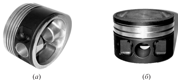
Рис. 5 Серийный «пятиколенный» литой поршень двигателя М-9Ф (а) и новый жидкостампованный «трехколенный» поршень разработки ФГУП ЦИАМ (б)
