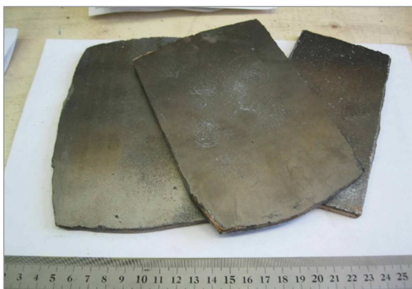
Изделия, полученные в условиях горения в режиме СВС и высокотемпературного сдвигового деформирования
