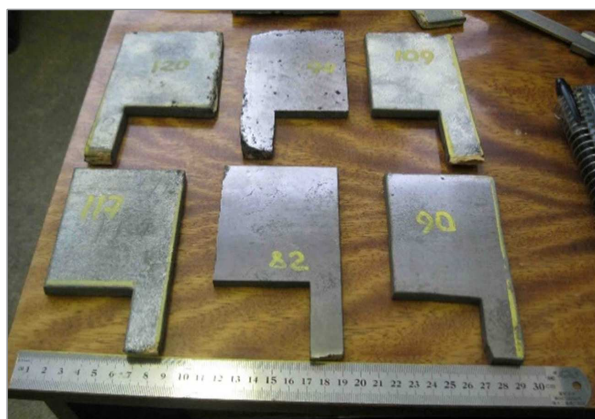
Изделия, полученные в условиях горения в режиме СВС и высокотемпературного сдвигового деформирования
